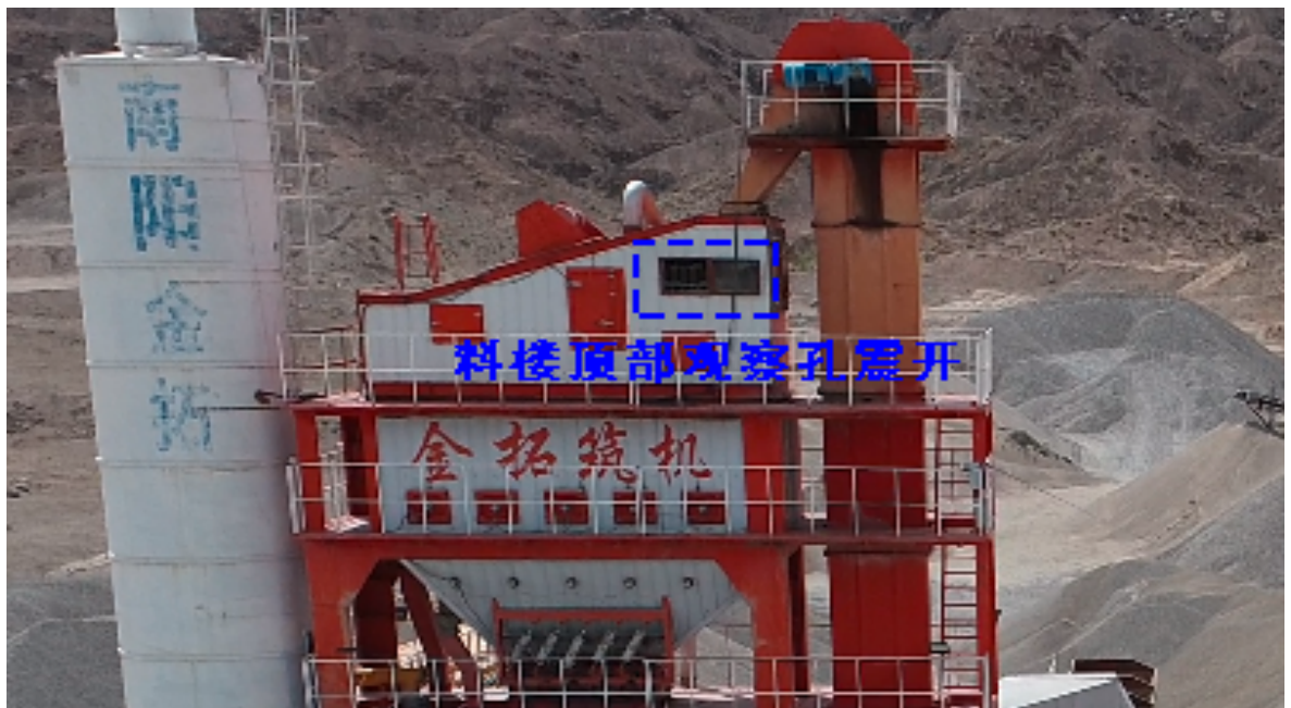
图 6 料楼顶部观察孔震开示意图
